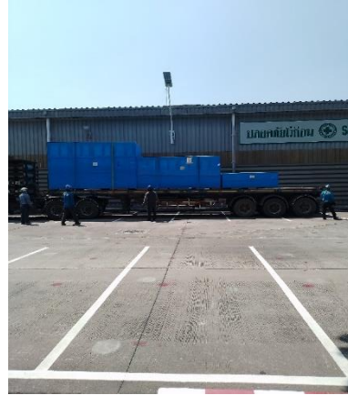
รูปที่ 1 การปิดคลุมรถบรรทุกขนส่งวัสดุอุปกรณ์
